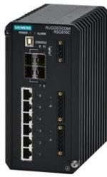
RUGGEDCOM RSG910C — это 10-портовый полностью управляемый Ethernet-коммутатор промышленного исполнения с интегрированной поддержкой IEEE 1588 для использования в жестких промышленных условиях. Изделие имеет 4 слота SFP 1 Гбит/с и 6 портов Ethernet RJ 45 10/100/1000 Мбит/с. Рабочая температура от -40°C до +85°C (без вентилятора).
