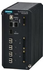
RUGGEDCOM RSG907R — это 7-портовый, полностью управляемый Ethernet-коммутатор промышленного исполнения с интегрированным HSR/PRP RedBox для использования в жестких промышленных условиях. Изделие имеет 3 слота SFP 1 Гбит/с и 4 многомодовых порта LC 100 Мбит/с (макс. 2 км). Рабочая температура от -40 °C до +85 °C (без вентилятора).
