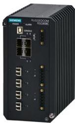
RUGGEDCOM RSG908C — это 8-портовый, полностью управляемый Ethernet-коммутатор промышленного исполнения с интегрированной поддержкой IEEE 1588 для использования в жестких промышленных условиях. Изделие имеет 4 слота SFP 1 Гбит/с и 4 многомодовых порта LC 100 Мбит/с (макс. 2 км). Рабочая температура от -40 °C до +85 °C (без вентилятора).
